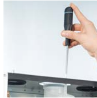
Rimozione vite blocco collettore fumi
