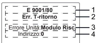
Fig. 8-1 Visualizzazione di un messaggio di errore corrente (errore di regolazione)
