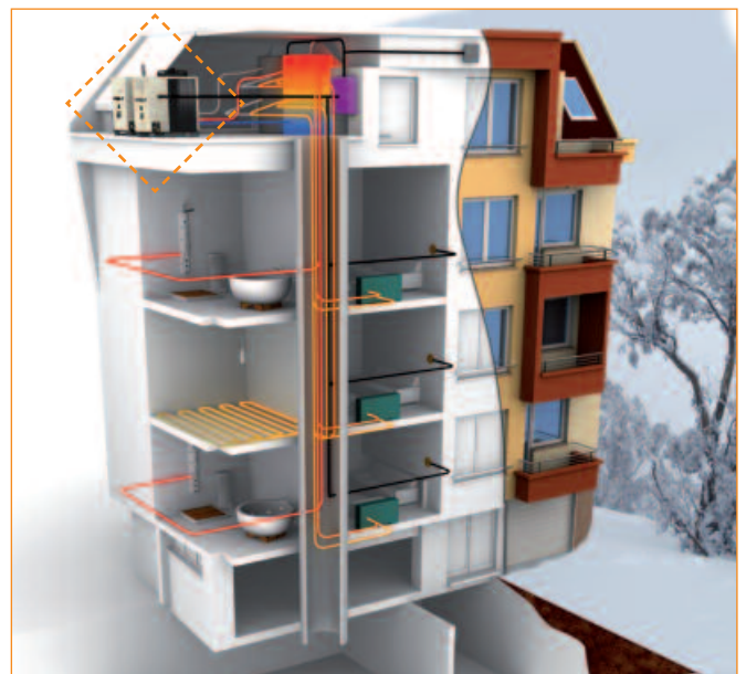
Esempio di applicazione in funzionamento estivo e invernale con impianto a pannelli radianti, fancoils, produzione indiretta ACS.
