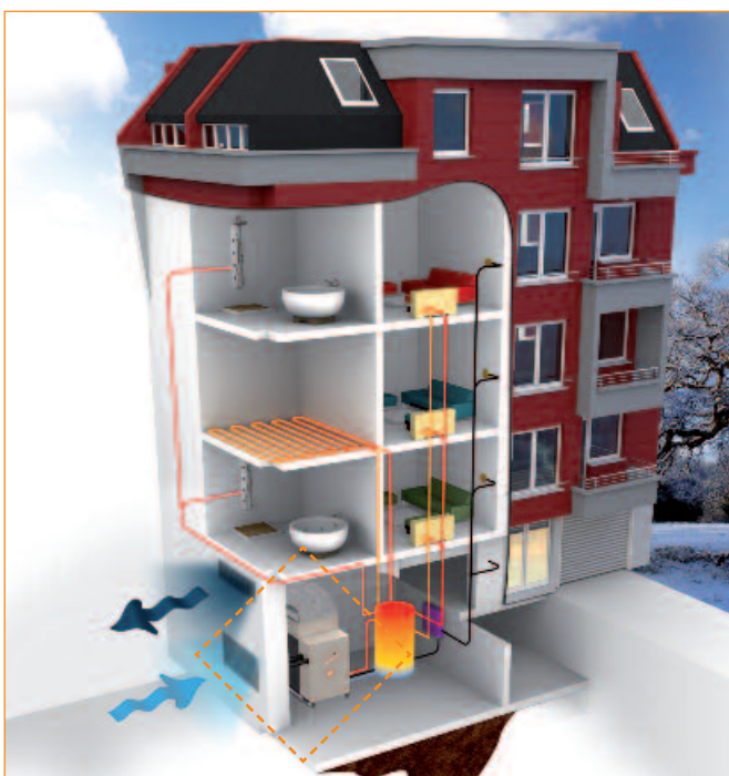
Esempi di applicazione della pompa di calore GAHP-A Indoor in centrale termica.
