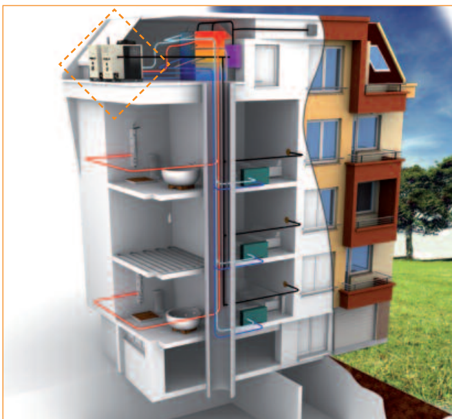
Esempio di applicazione in funzionamento estivo e invernale con impianto a pannelli radianti, fancoils, produzione indiretta ACS.
