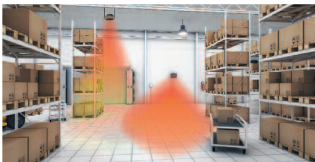
Fase2 - attivazione degli aerotermini per raggiungere il livello di temperatura impostato dall'utente
