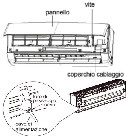
2. Inserire il cavo di collegamento tra l'unità interna ed esterna nel foro posteriore corrispondente alla morsettiera. Poi estrarlo dal lato anteriore.
