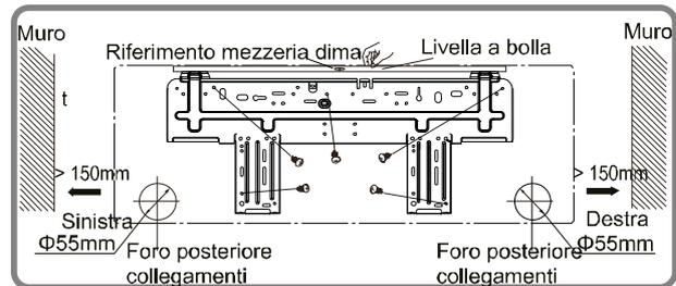
Praticare il foro tubazioni di diametro  $\Phi 55$  nella posizione d'uscita appositamente scelta. Per un drenaggio corretto, il foro tubazioni sulla parete deve essere leggermente inclinato verso il basso sul lato esterno, con pendenza di 5-10°.
