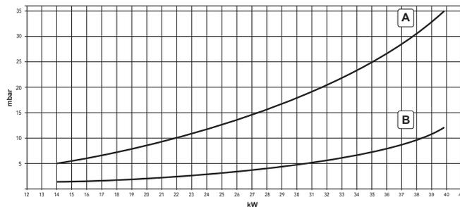
fig. 37 - Diagramma pressione/potenza DIVAtop MICRO F 37
