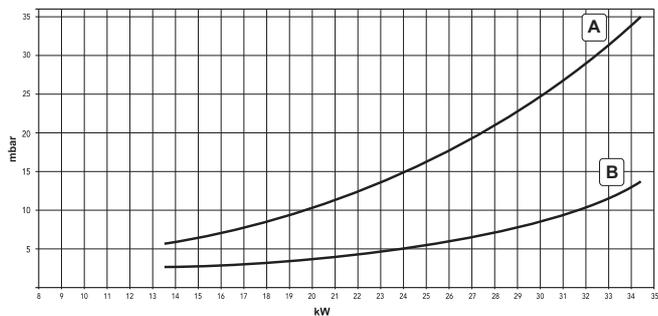
fig. 35 - Diagramma pressione/potenza DIVAtop MICRO F 32
