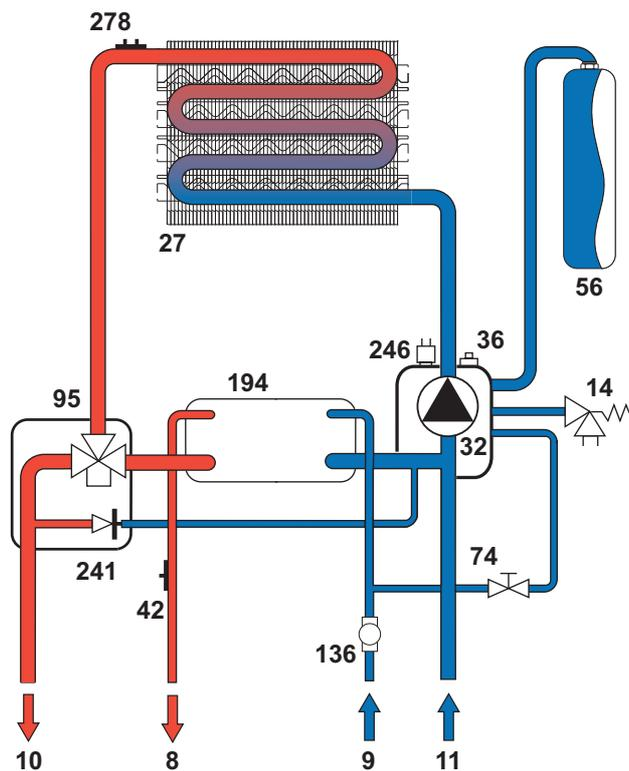
fig. 32 - Circuito idraulico
