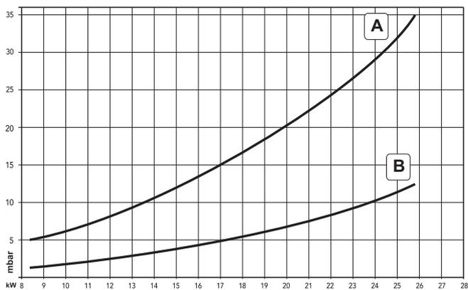
fig. 33 - Diagramma pressione/potenza DIVAtop MICRO F 24
