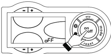
fig. 7 - Spegnimento caldaia
