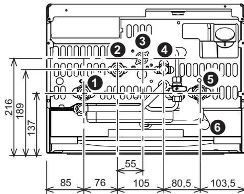
fig. 17 - Attacchi idraulici
