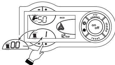
fig. 25 - Modalità TEST (potenza riscaldamento = 100%)
