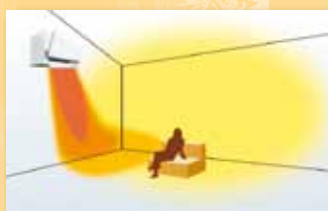
Funzione Comfort in modalità riscaldamento
