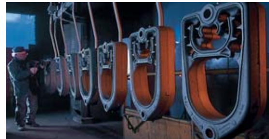
Nella fonderia a Lollar si producono le caldaie in ghisa. Qui un operaio controlla gli elementi per testarne la qualità.
