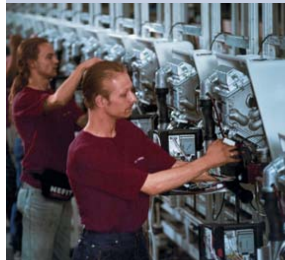
La catena di montaggio delle caldaie murali a condensazione a Deventer in Olanda.
