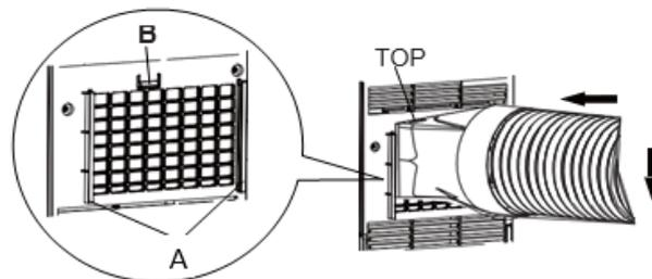
Collegare alla parte finale del tubo flessibile il raccordo circolare per finestra(1) e successivamente il raccordo terminale per finestra (2) così ottenuto unendo le parti A e B.
