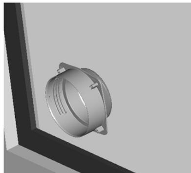
3. Inserire il raccordo circolare per kit oblò nel tubo flessibile retrattile e inserire il tubo flessibile retrattile con raccordo circolare nell'oblò privo del tappo.
