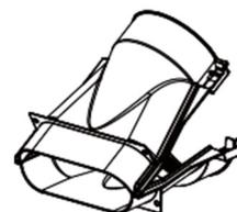
Raccordo piatto da posizionare tra la bocca di espulsione dell'aria e il tubo flessibile
