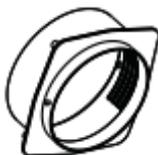
Raccordo terminale per finestra fornito suddiviso in due parti da unire con 2 linguette che si incastrano (2).
