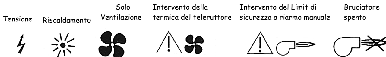
Figura 1 Simboli grafici presenti sui comandi e sui dispositivi di allarme.
