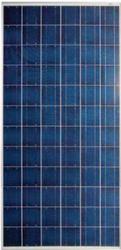
Modulo ad alta potenza composto da 72 celle policristalline 6" da 156x156 mm connesse in serie.
