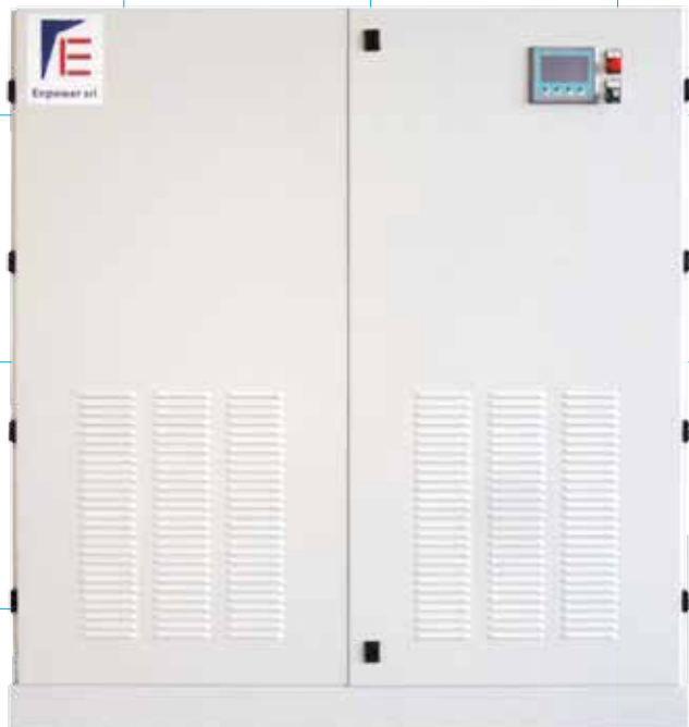
Quadro di accumulo ibrido in isola EN3312 Potenza fotovoltaico max 10kwp Energia nominale accumulata 20kwh Ingresso lato AC 1P+N 230v 50hz Pmax 10kw Uscita Ac 1P+N 230v 50hz Pmax 10kw
