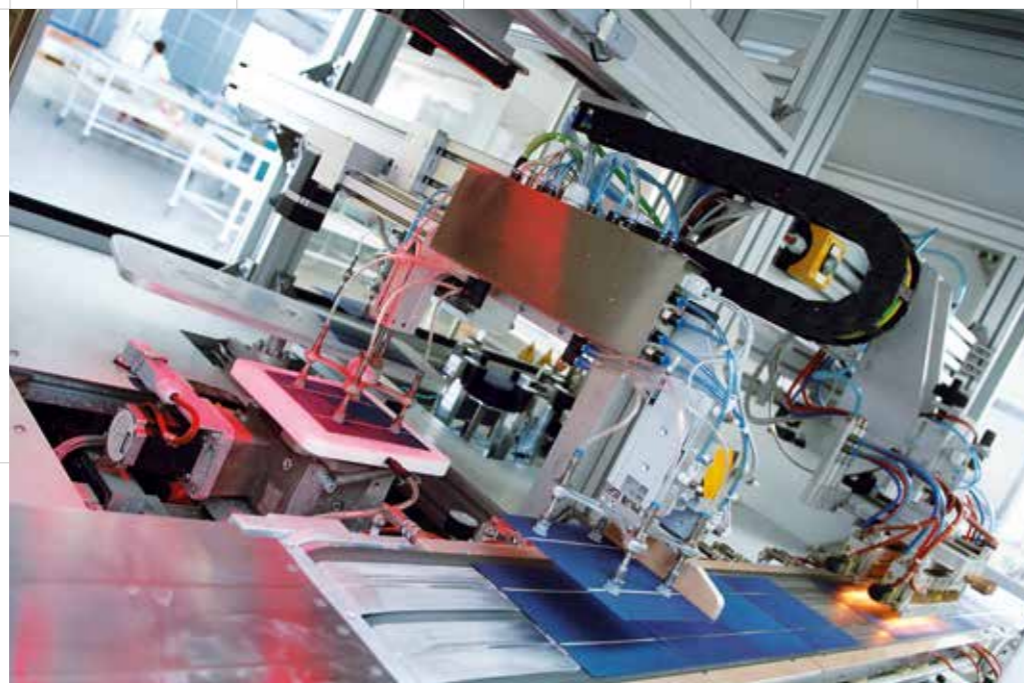
Caricamento celle e centratura automatica mediante sistema computerizzato e deposito su nastro trasportatore con posizionamento ribbon in preparazione alla saldatura
