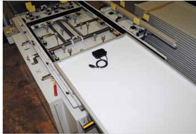
Incorniciatura del pannello con profilo in alluminio perimetrale mediante macchina automatica a pressione
