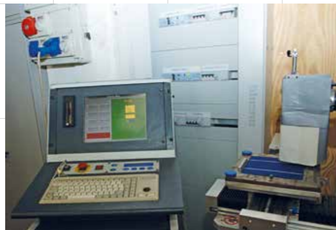
Automatismo Laser per taglio celle in funzione del prodotto da realizzare
