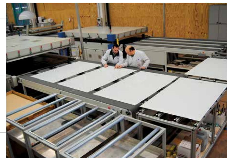
Uscita pannelli laminati e successivo raffreddamento naturale per consolidamento fisico dei materiali
