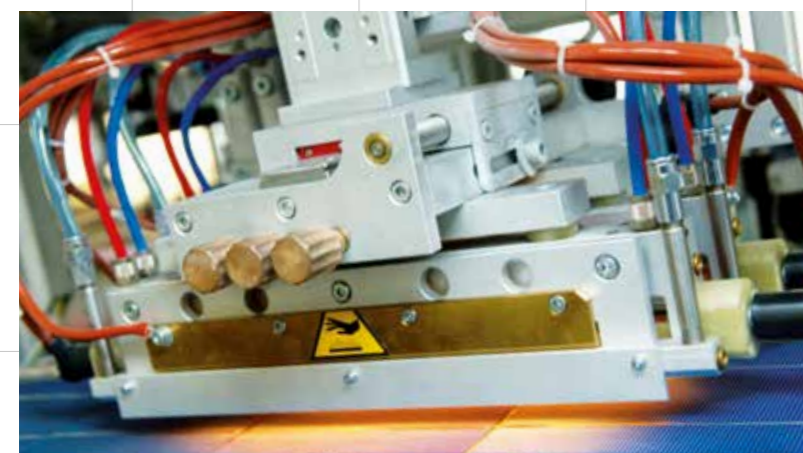
Saldatura automatica celle a caldo con temperature variabili e formazione stringa
