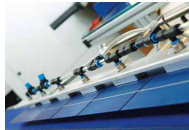
Spostamento automatico con rotazione di 180° per controllo visivo stringa e distribuzione della stessa sulla superficie del vetro precedentemente preparata con primo foglio di E.V.A.
