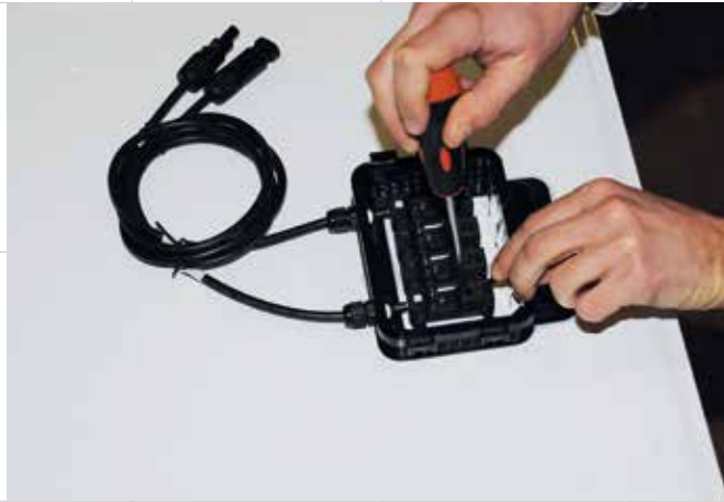
Rifinitura del pannello tramite sbordatura, posizionamento nastro perimetrale biadesivo ed applicazione scatola di giunzione a 3 diodi con relativa sigillatura
