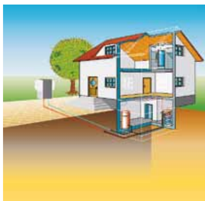
Schema impianto - Installazione esterna
