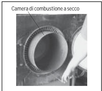
Figura: camera di combustione a secco
