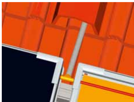
Dettaglio montaggio collettori Vitosol 200-F SVK
