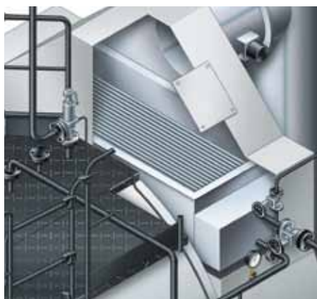
Dettaglio dell'economizzatore integrato in un generatore di vapore
