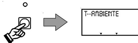
Per tornare al livello superiore **INSTALLAZ** ruotare la manopola di navigazione/modifica (F) fino a visualizzare sul display **INDIETRO** quindi premere sul tasto di programmazione (C).
