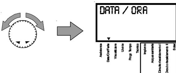
Premere il tasto di programmazione (C), viene visualizzato il livello **ORA--DATA**
