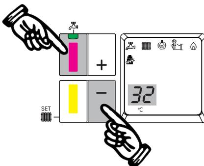
Il valore impostato viene visualizzato sul display "U".
