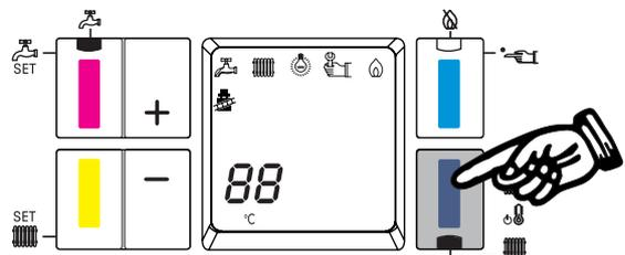
In queste condizioni la caldaia non produce nè riscaldamento nè acqua calda sanitaria.
