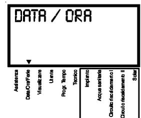
Premere il tasto di programmazione (C), viene visualizzato il livello **ORA--DATA**
