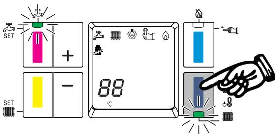
Regolare la temperatura riscaldamento mantenendo premuto il tasto GIALLO "B" e contemporaneamente premendo sul tasto "+" per aumentare o "-" per diminuire.
