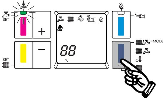
Regolare la temperatura di prelievo dell'acqua per uso sanitario mantenendo premuto il tasto VIOLA "C" e contemporaneamente premendo sul tasto "+" per aumentare o "-" per diminuire.
