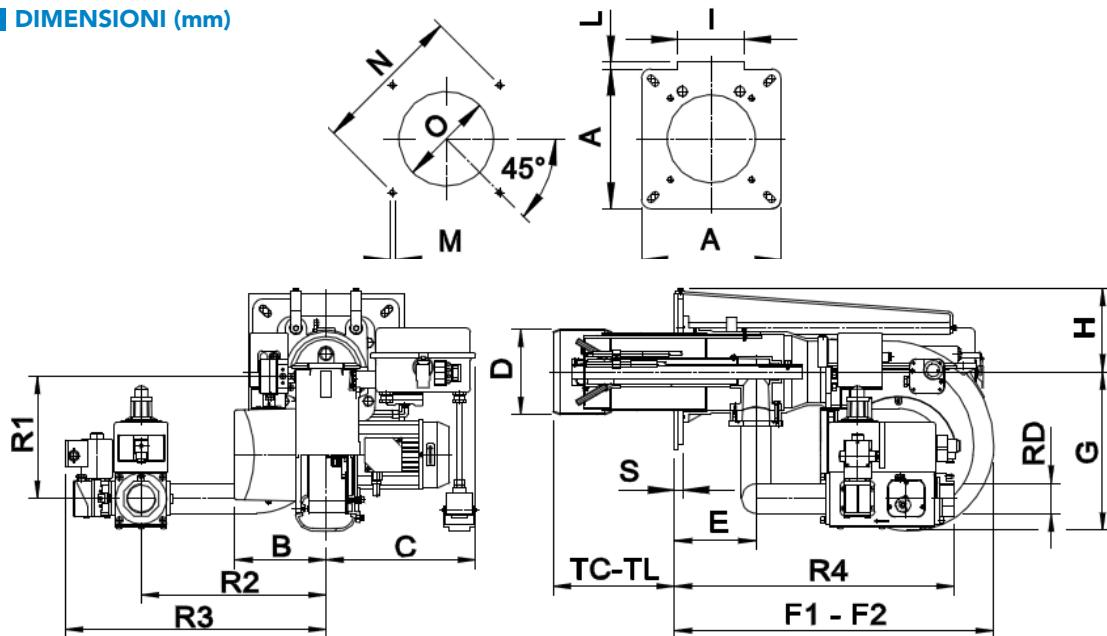
F2 = ingombro a bruciatore arrestato in posizione di manutenzione
